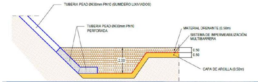
En el interior de la tubería, que actúa de camisa y protección se introducirá la bomba de extracción de lixiviados que se conectará a la red de conducción existente, que conducirá los mismos hasta la balsa de almacenamiento de lixiviados ubicada en la Zona C3.
