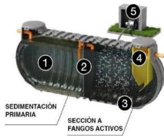
1. SECCIÓN DE SEDIMENTACIÓN Y DIGESTIÓN DE LODOS: zona de calma en la cual las aguas residuales se depositan y acumulan en el fondo. La flora bacteriana transforma el componente putrescible de los lodos en fango inerte, dióxido de carbono y agua.
