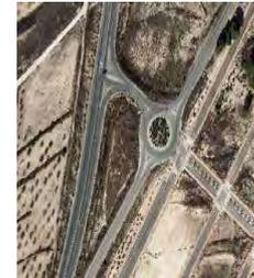
DETALLE 0 Rotonda situada a 3 km aproximados de la instalación, permitiendo realizar un cambio de sentido de los vehículos que vienen en sentido Cehegín - Collaposo, para llegar al pto. de acceso a la instalación proyectada.
